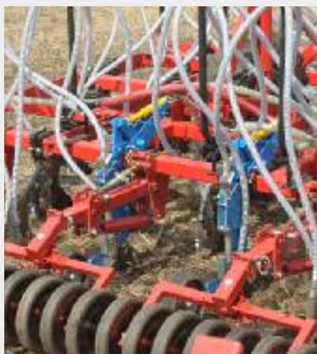
Deux dents du semoir de précision Primary (en bleu) installées sur un semoir pneumatique Kverneland 12 m
